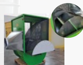
Slittamento della griglia interna del separatore rotativo Slipping of the internal grid of the rotative separator
