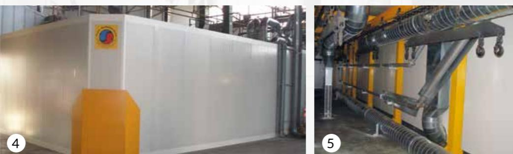
5 Forno di asciugatura e tubazioni radianti
